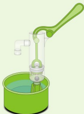
自制抽水机 Homemade pump
