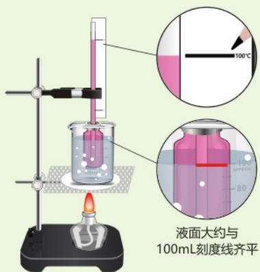
自制简易温度计 Homemade simple thermometer
